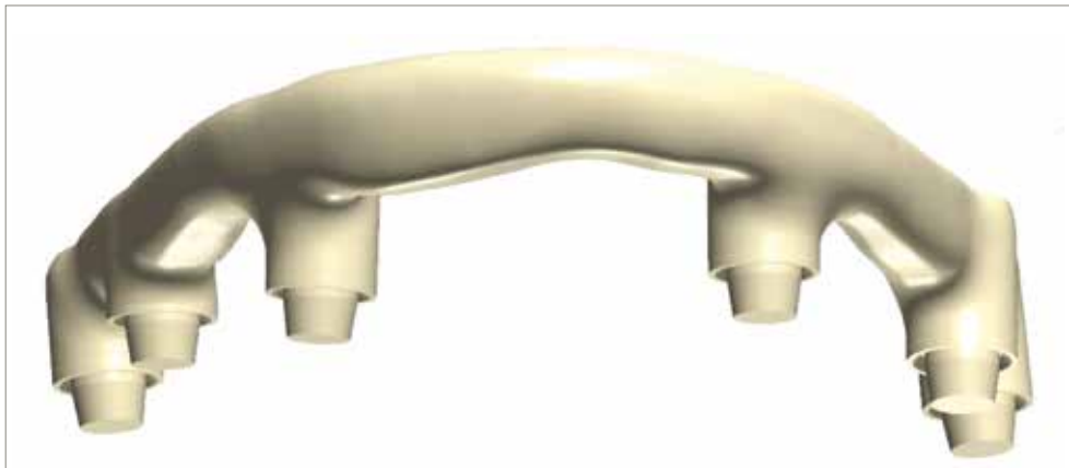
Figura 7. Diseño de la férula de verificación de pasividad, para comprobar la fiabilidad del modelo digital.
